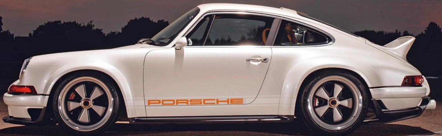
La carrozzeria della 964 d'origine viene modificata dalla Singer con elementi di fibra di carbonio, che consentono di contenere la massa della vettura; l'ala posteriore richiama quella a coda d'anatra di modelli come la 2.7 RS. Per il motore, completamente rivisto, la scelta è tra due versioni con cubatura da 3.8 litri e una da 4.0 litri
