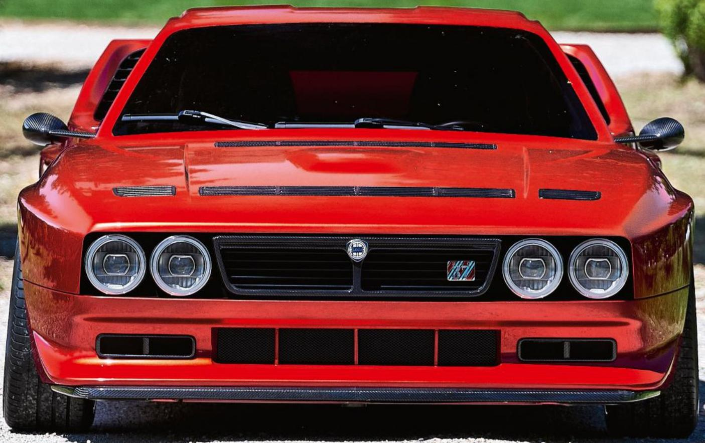
La bella linea della 037 d'origine, opera della Pininfarina, non viene intaccata dalle modifiche attuate dalla Kimera: cambiano un po' il frontale, con una griglia differente e uno splitter che rende omaggio a quello della Delta S4, e le proporzioni, anche per la riduzione dello sbalzo anteriore. I quattro fari circolari, tipici della vettura, adottano la tecnologia full Led
