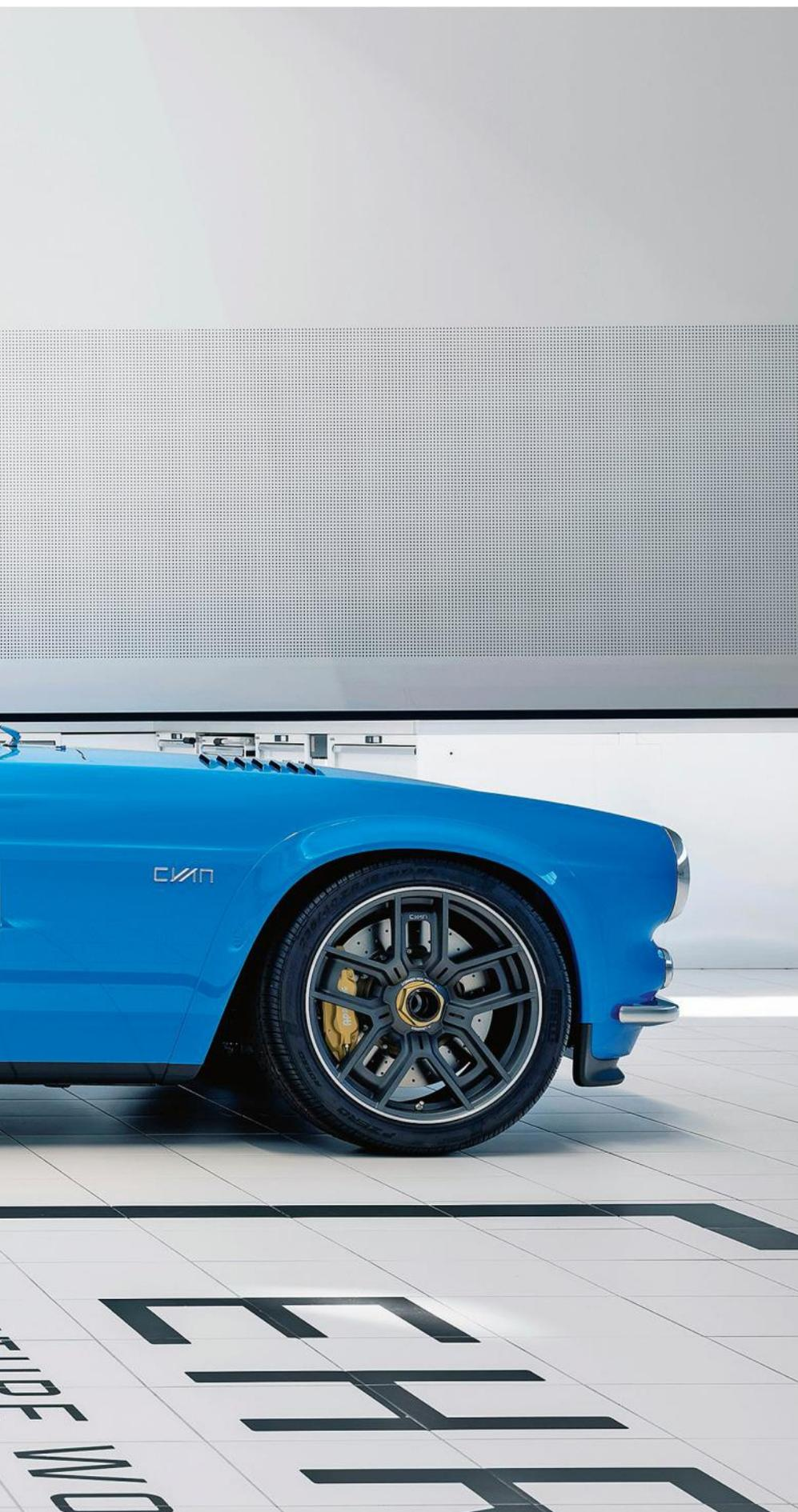
La bella linea della Volvo P1800 resta quasi inalterata: i colori della carrozzeria, di acciaio e fibra di carbonio, sono quelli tipici svedesi, adottati anche dal team Cyan Racing. L'abitacolo sfoggia sedili da competizione e strumentazione digitale; i freni hanno dischi di acciaio e pinze con quattro pistoncini, ma non c'è l'Abs
